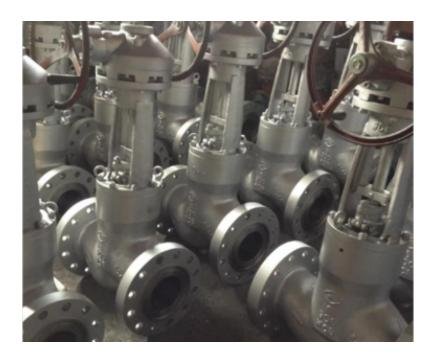
优点1、流动阻力小。阀体内部介质通道是直通的,介质成直线流动,流动阻力小。2、启闭时较省力。是与截止阀相比而言,因为无论是开或闭,闸板运动方向均与介质流动方向相垂直。3、高度大,启闭时间长。闸板的启闭行程较大,升降是通过螺杆进行的。4、水锤现象不易产生。原因是关闭时间长。5、介质可向两侧任意方向流动,易于安装。闸阀通道两侧是对称的。6、结构长度(系壳体两连接端面之间的距离)较小。7、形体简单,结构长度短,制造工艺性好,适用范围广。8、结构紧凑,阀门刚性好,通道流畅,流阻数小,密封面采用不锈钢和硬质合金,使用寿命长,采用PTFE填料,密封可靠,操作轻便灵活。
